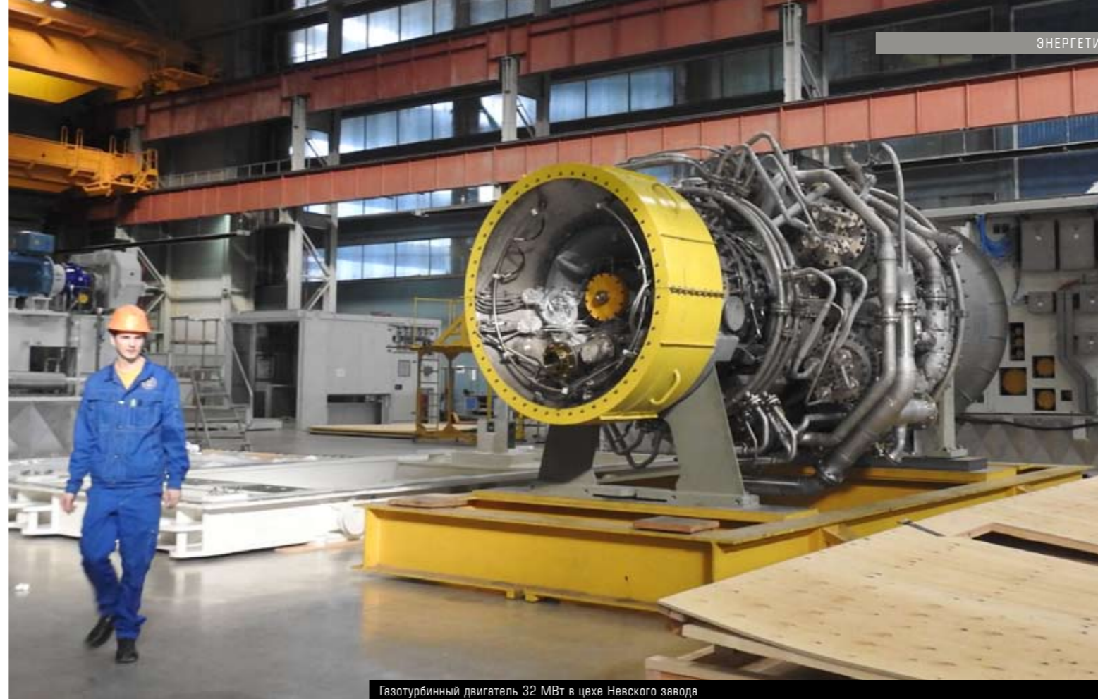
Газотурбинный двигатель 32 МВт в цехе Невского завода
