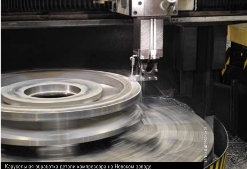
Карусельная обработка детали компрессора на Невском заводе
