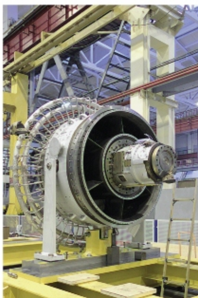
Фото 8. Турбина низкого давления на базе силовой турбины PGT25+
