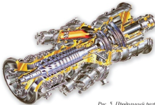
Рис. 5. Продольный разрез MS5002E
