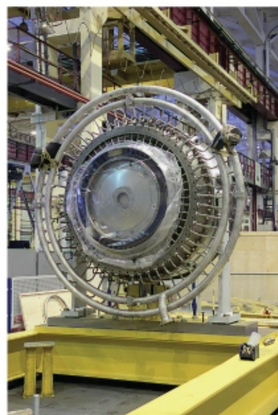
Фото 8. Турбина низкого давления на базе силовой турбины PGT25+
