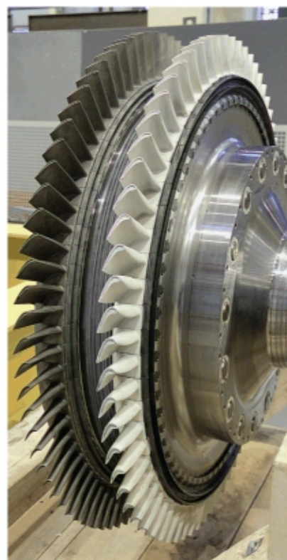
Фото 7. Турбина высокого давления с рабочими лопатками
