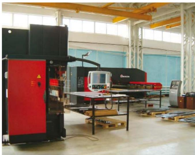
Производственный процесс складывается из следующих этапов: обработка листового металла на металлообрабатывающих станках компании Amada (Япония); сборка и обварка деталей на сварочном участке, с последующим порошковым покрытием на автоматической
